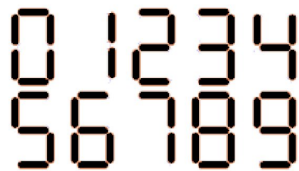
Рис. 1: Примеры того, как на 7-сегментном индикаторе отображаются все цифры.
